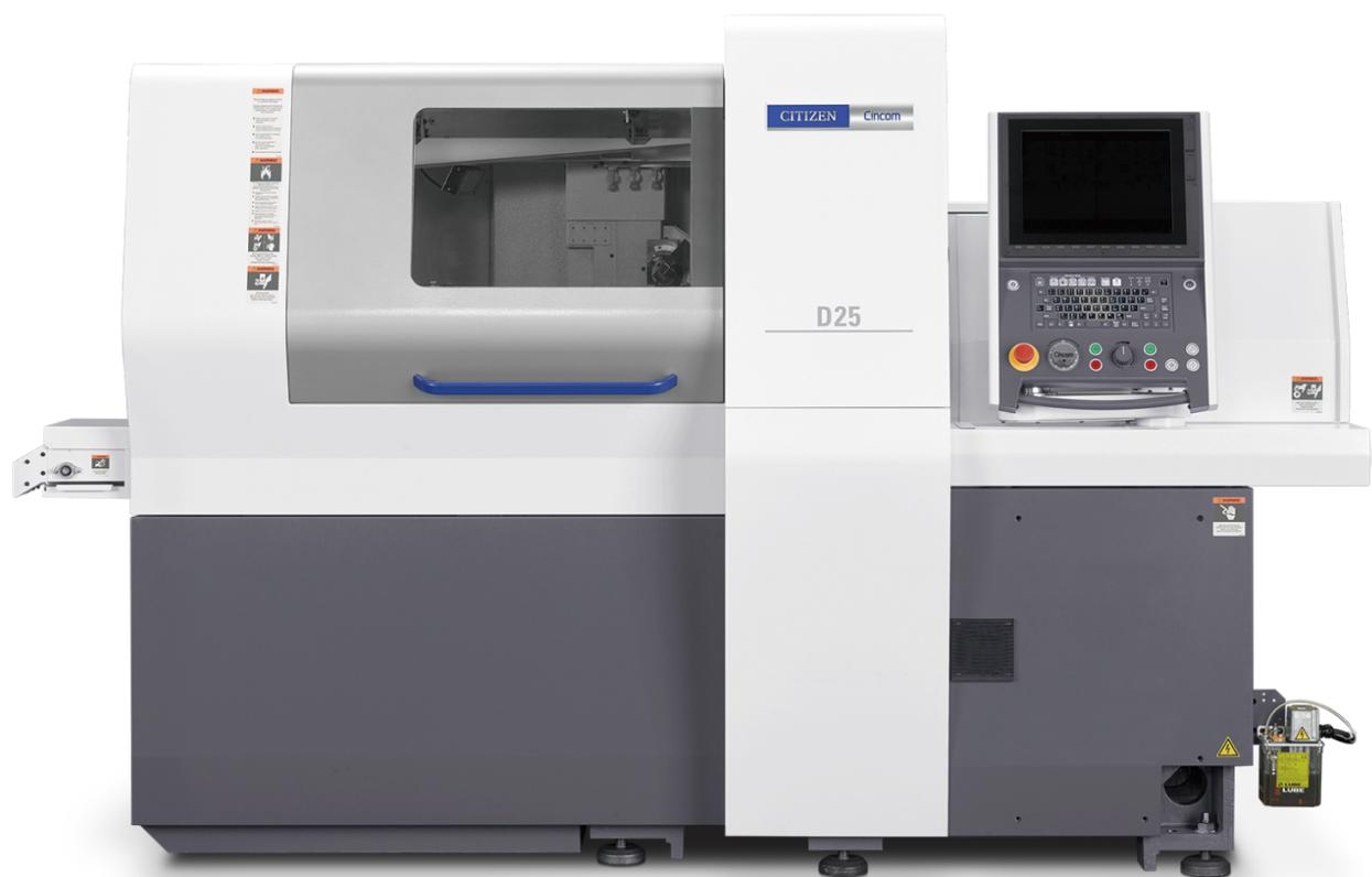
Macchina che permette lavorazioni in simultanea con tre utensili. Caratterizzata dalla versatilità delle varie piastre, da asse B e 5 assi in continuo, è convertibile con o senza bussola ed equipaggiata con tecnologia LFV.
